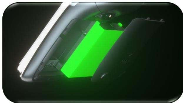
リン酸鉄リチウムイオン電池は、従来のリチウムイオン電池に比べ、熱安定性が高く、安全に動作。
